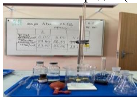
2-Сурет. Концентрациясы белгісіз ерітіндідегі сілті мөлшерін анықтау
